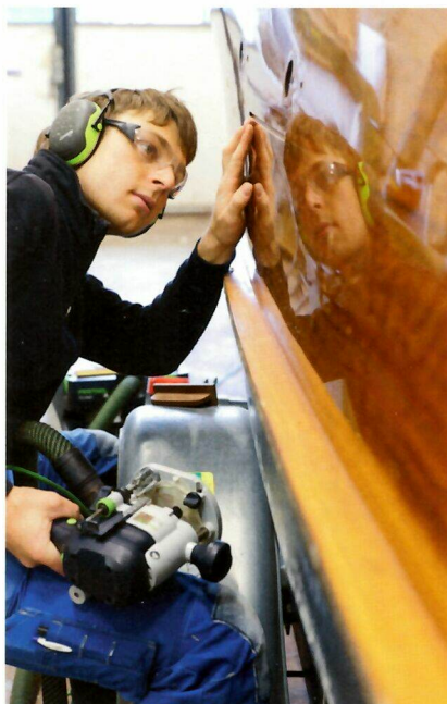
> Reparaturen Einen spröden Rumpf bearbeiten die Berufsleute mit einer Oberfräse.
