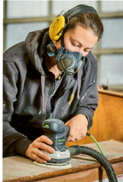
< Oberflächen schleifen Bevor sie das Boot neu lackieren, schleifen die Profis den alten Lack weg.
