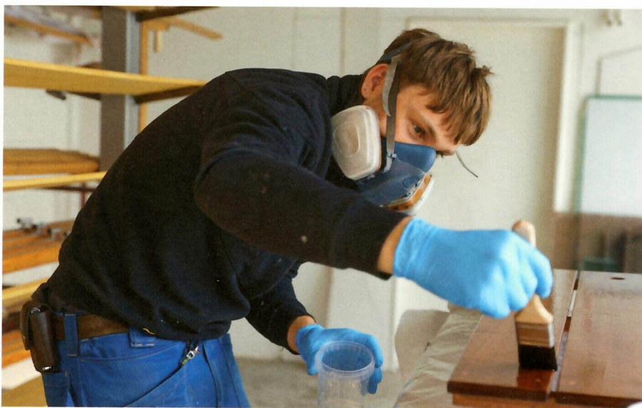
▲ Während Tim Glauser das Holz eines neuen Ruderboots lackiert, trägt er eine Maske mit Aktivkohlefilter.
