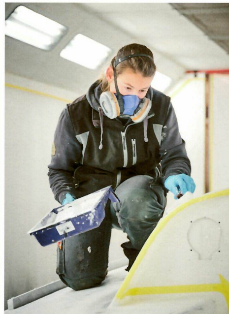
< Oberflächen lackieren Die Bootbauerinnen und Bootfachwarte tragen Lacke und Farben auf Boote in Spritzkabinen auf. Spezielle Farben streichen sie von Hand auf.
